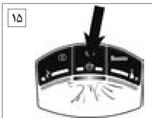
کنترل مواد معدنی به صورت خودکار تولید بخار را قطع خواهد کرد. در این صورت چراغ راهنمای صورت مداوم روشن خواهد ماند. برای تولید مجدد بخار باید کارتیریج ضدرسوب تعویض شود و یا از آب مقطر استفاده شود. بعد از تعویض کارتیریج، اتو باید خاموش و روشن شود تا به شرایط اولیه برگردد.
