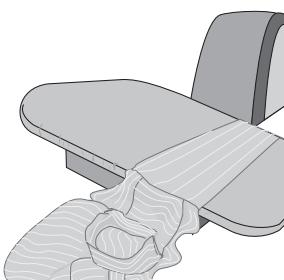
۲۳- خاتمه اتوکشی آستین‌ها آستین را با زاویه، روی صفحه اتو قرار داده و پرس کنید.
