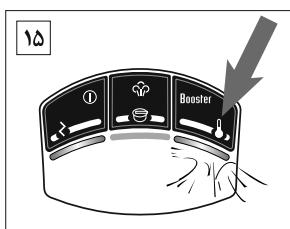
با روشن کردن اتو، چراغ راهنمای دما نیز به طور همزمان روشن می‌شود. بعد از رسیدن دما به حد انتخاب شده توسط کلید ترمومترات، چراغ راهنمای خاموش می‌شود. در زمان اتوکشی این چراغ به طور متناوب خاموش و روشن می‌شود.
