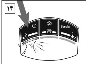
پس از وصل اتو به برق، کلید اصلی روشن/خاموش را فشار دهید. چراغ قرمز، نشان‌دهنده گرم شدن صفحه داغ‌شونده و کارکردن مولد بخار است.
