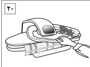
۲۰- برای پرس کردن به صورت خودکار، اتورا بیندید، برای چند ثانیه اتورا در حالت بسته نگه دارید تا پارچه کاملاً خشک و اتو شود.
