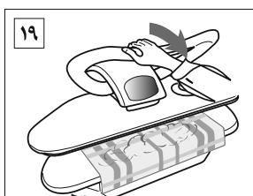
۱۹- صفحه داغ شونده را بوسیله دسته پایین آورید. با رسیدن صفحه به حالت نیمه بسته، دستگاه به صورت خودکار تازمانی که لازم باشد شروع به تولید بخار می کند.
